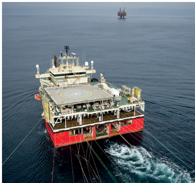
Operación de sísmica en el mar
